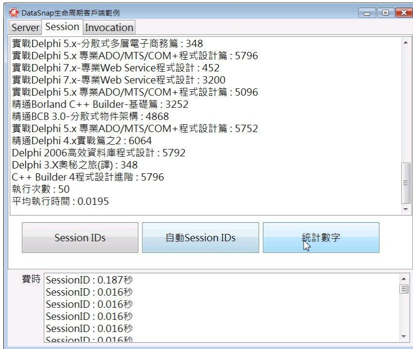
圖 6-7 使用 Session 生命週期的服務物件並且開啟 dbExpress 連結池功能服務用戶端的請求
