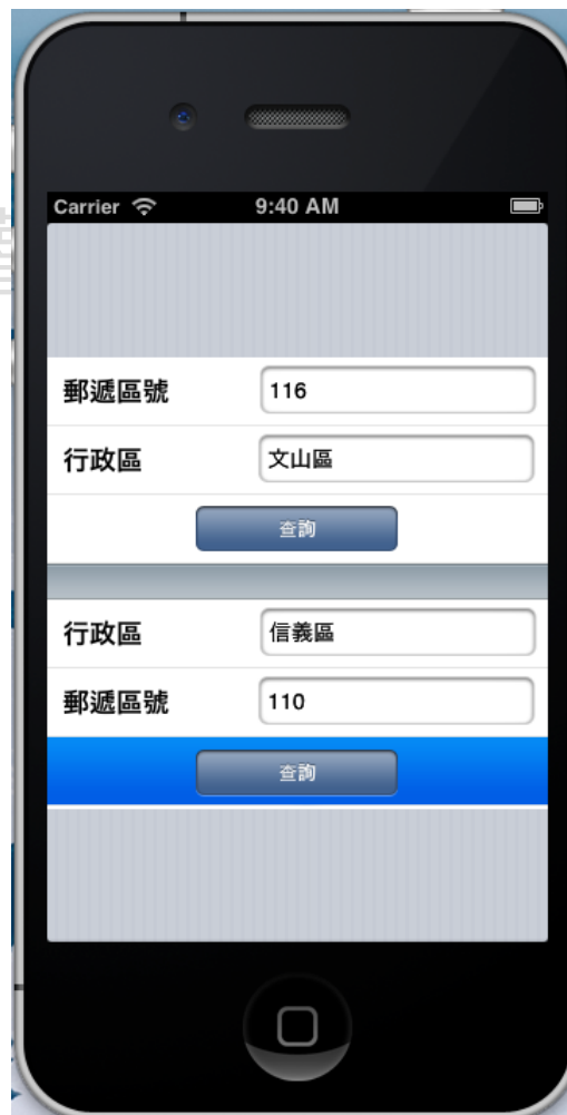
圖 24 範例 iOS App 成功的在 iOS Simulator 中呼叫遠端的範例 DataSnap 伺服器
