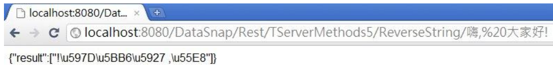
圖 1-8 使用瀏覽器呼叫 DataSnap 伺服器中的範例方法
