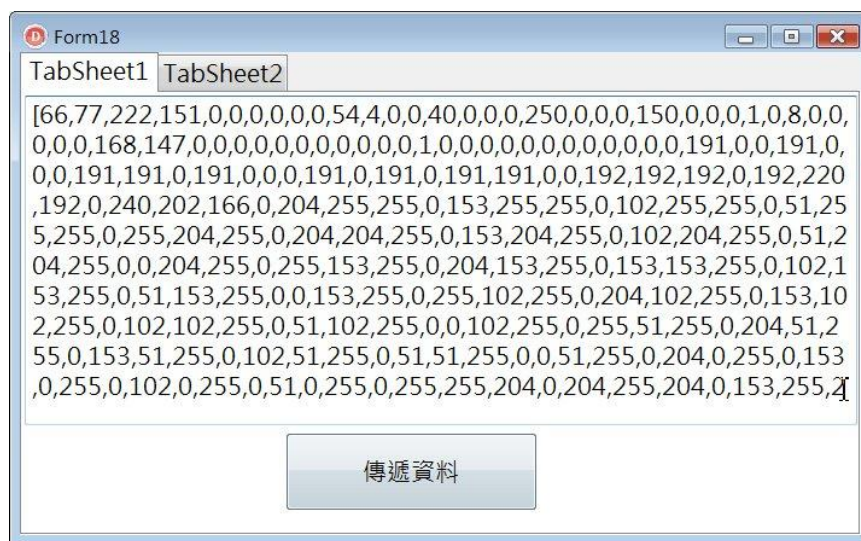
圖 18 以 JSON 型態封裝的圖形資料
