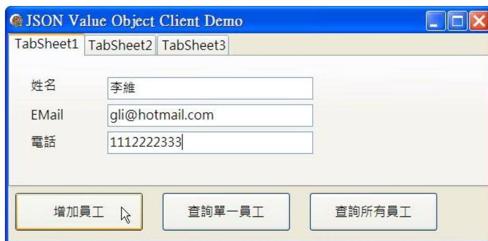
圖 11 用戶端應用程式呼叫遠端 AddEmployee 方式加入員工資訊
