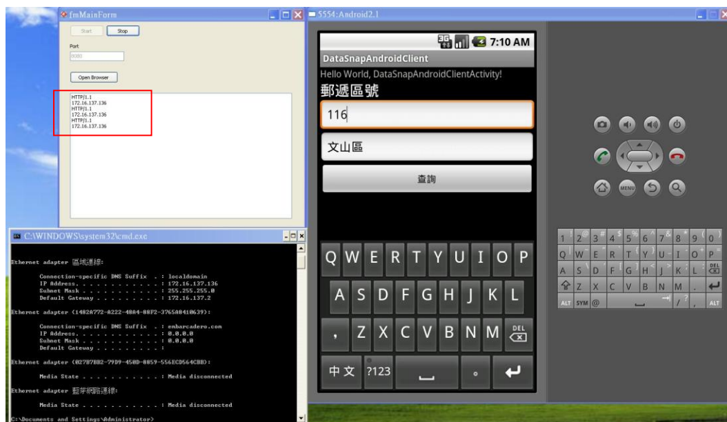
圖 19 在 Simulator 中執行 Android App 成功的連結 DataSnap 伺服器並且呼叫其中的服務
